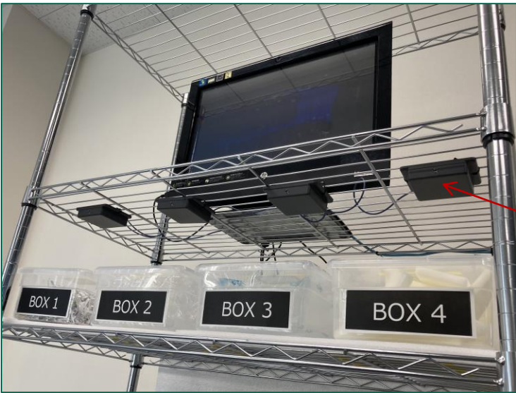
ディジーチェーンR/Wの設置の様子（R/W間ハーネス 約40cm）
