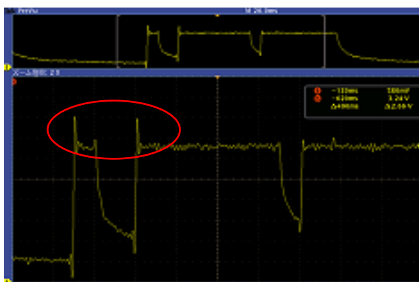
図 1: 異常発生時の電源波形例
